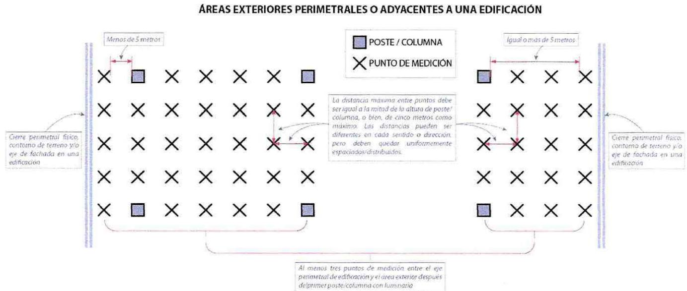
**Figura 3. Detalle de grilla de medición para alumbrado industrial (Fuente: Consultoría Antecedentes para actualización de procedimientos Nueva Norma Lumínica, 2023)**
