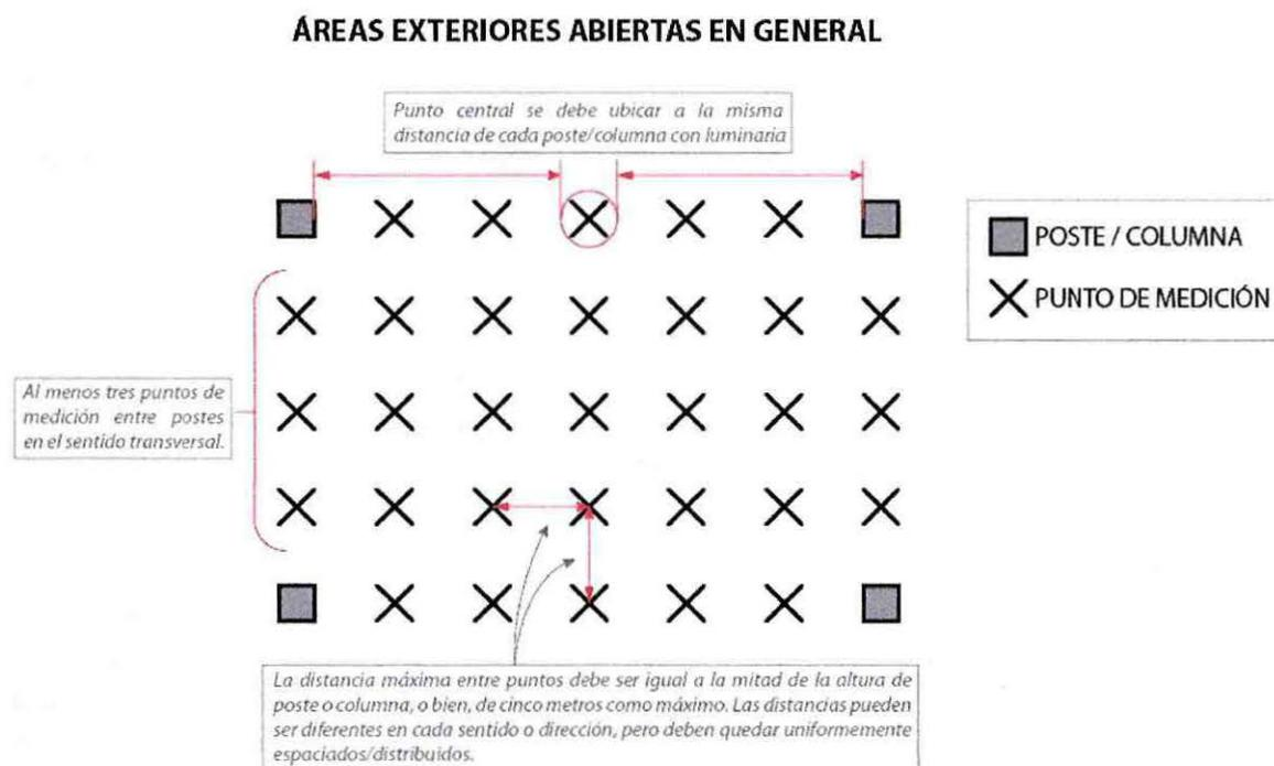
**Figura 2. Detalle de grilla de medición para alumbrado industrial (Fuente: Consultoría Antecedentes para actualización de procedimientos Nueva Norma Lumínica, 2023)**
