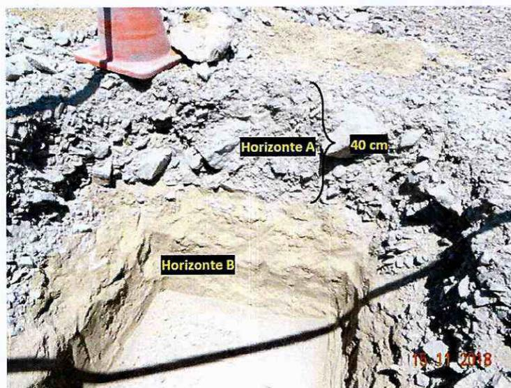
Imagen N° 2. Se puede apreciar la calicata N° 1, correspondiente al tranque N° 4. En ella se aprecia dos horizontes claramente definidos, el primero de ellos se midió en terreno alcanzando una profundidad de 40 centímetros.
